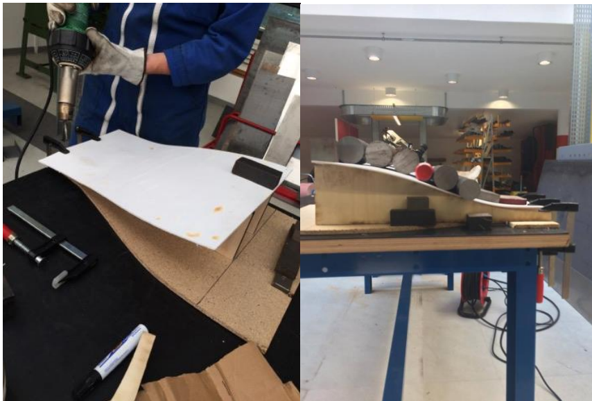
Fig 3.3 : Pliage des plaques du convergent
